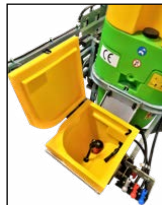
Rozwadniacz boczny na opryskiwaczu zawieszanym
