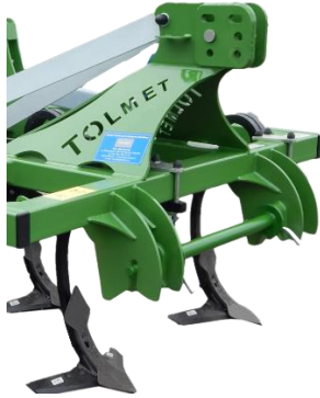
Zdj.3. Trzypunktowy układ zawieszania z automatyczną belką zaczepową (opcjonalnie)
