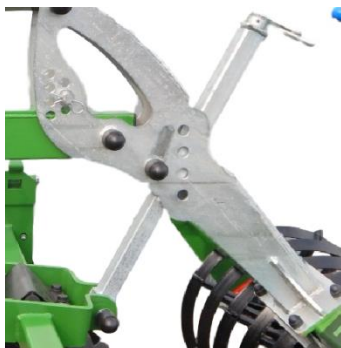
Rys.13.Łącznik nastawny regulujący wysokość położenia talerzy.
