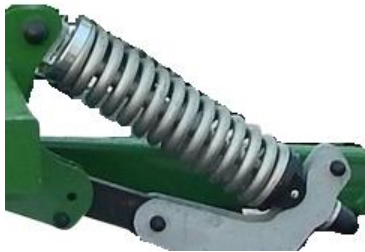
Rys.6. Zabezpieczenie sprężynowe zęba.
