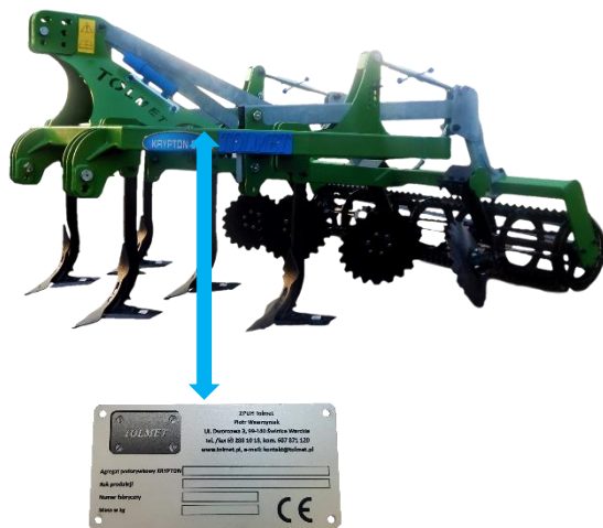
Zdj. 1. Umieszczenie tabliczki znamionowej na maszynie.
