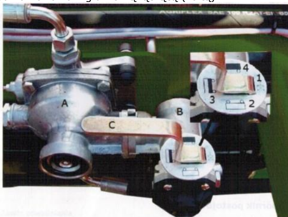
Zdj.4. Zawór sterujący i regulator siły hamowania
