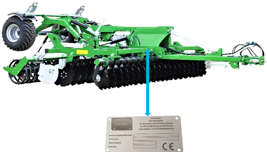
Zdj. 1. Umieszczenie tabliczki znamionowej na maszynie.
