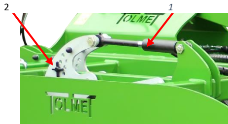
Rys.4. Hydrauliczna regulacja głębokości roboczej. 1. Układ trapezowy. 2. Sworzeń regulacji głębokość roboczej
