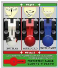
Rys.49. Funkcje rozwadniacza bocznego
