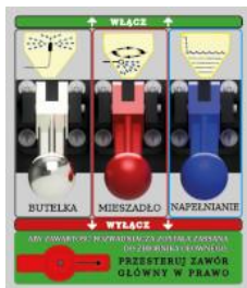
Rys.19. Funkcje rozwadniacza bocznego
