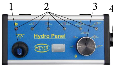
Rys.32. Hydro Panel ®. 1. Włącznik. 2. Diody trybu pracy. 3. Pokrętło zmiany trybu pracy. 4. Przyłącze elektryczne.
