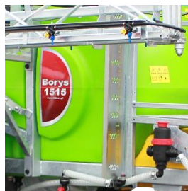
Rys.46. Miernik wody zbiornika głównego
