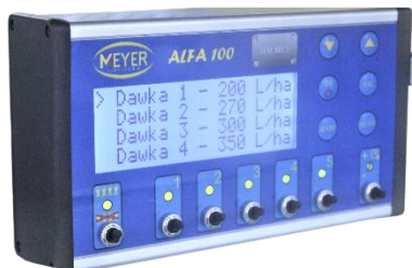
Rys. 45. Komputer Alfa 100. Opcjonalny sterownik Control Panel 4. Funkcje: Włącz/Wyłącz, regulacja ciśnienia., włącz/wyłącz każdą sekcję osobno, dawka dostosowywana do prędkości ciągnik/opryskiwacz, pamięć. Jest przejrzysty, łatwy w obsłudze, sygnalizuje zbyt szybką/wolną jazdę co uniemożliwia zastosowanie odpowiedniej dawki.
