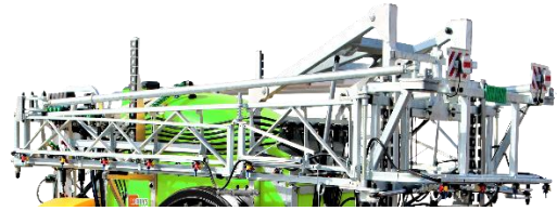
Rys.11. Belka polowa hydraulicznie rozkładana
