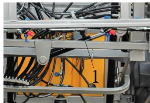
Rys.34. Stabilizacja hydrauliczna opryskiwacza „BORYS”. 1. Siłownik hydrauliczny stabilizujący belkę polową..
