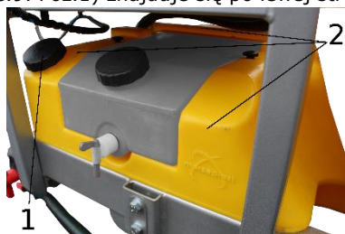
Rys.9. 1. Wlew na wodę do mycia układu. 2. Zbiornik na wodę do mycia układu.
