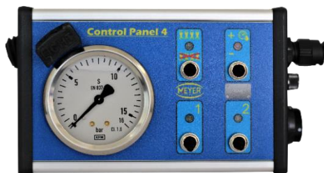
Rys. 42. Opcjonalny sterownik Control Panel 4. Funkcje: Włącz/Wyłącz, regulacja ciśnienia., włącz/wyłącz skrajne sekcje.
