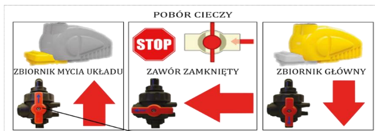
Rys.30. Obsługa zaworu trójdrożnego. 1. Pokrętło.
