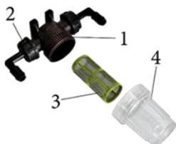
Rys. 49. Filtr liniowy 1. Korpus filtra liniowego. 2. Kolano 45st. 3. Sitko filtra liniowego. 4. Obudowa filtra liniowego
