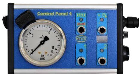
Rys. 38. Opcjonalny sterownik Control Panel 4. Funkcje: Włącz/Wyłłącz, regulacja ciśnienia., włącz/wyłłącz skrajne sekcje.
