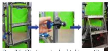
Rys.24. Otwieranie drabinki umożliwiającej dostęp do podestu.
