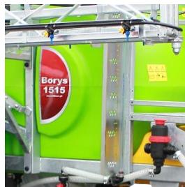
Rys.40. Miernik wody zbiornika głównego
