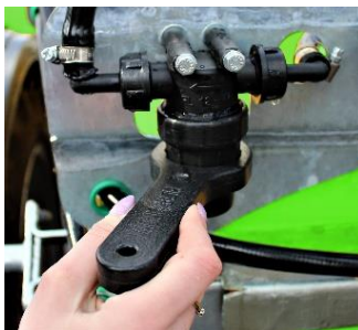
Rys. 49. Filtr liniowy 1. Korpus filtra liniowego. 2. Kolano 45st. 3. Sitko filtra liniowego. 4. Obudowa filtra liniowego
