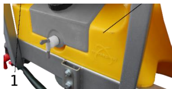
Rys. 9. 1. Wlew na wodę do mycia układu. 2. Zbiornik na wodę do mycia układu.
