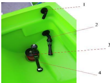
Rys. 8. Rozwadniacz boczny 1- otwór wlewu cieczy; 2- mieszadło hydrauliczne; 3- odpływ z sitem; 4- dysza obrotowa
