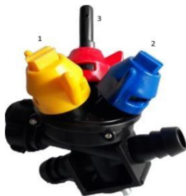
Rys.34.Głowica potrójna. 1-Dysza RS 02; 2-Dysza RS 03; 3- Dysza RSM
