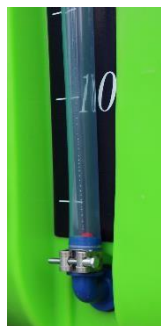
Rys.6. Miernik wody zbiornika głównego
