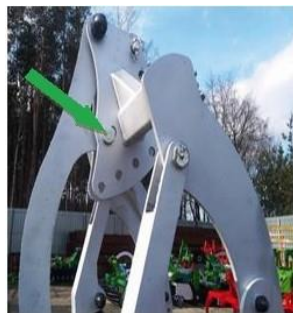
Zdj.3. Hydropak pozycja transportowa i miejsce zabezpieczenia na czas transportu
