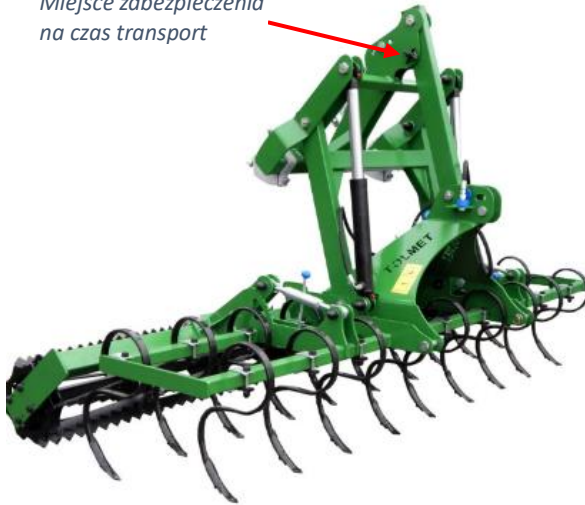
Zdj.3. Hydropak pozycja transportowa i miejsce zabezpieczenia na czas transportu
