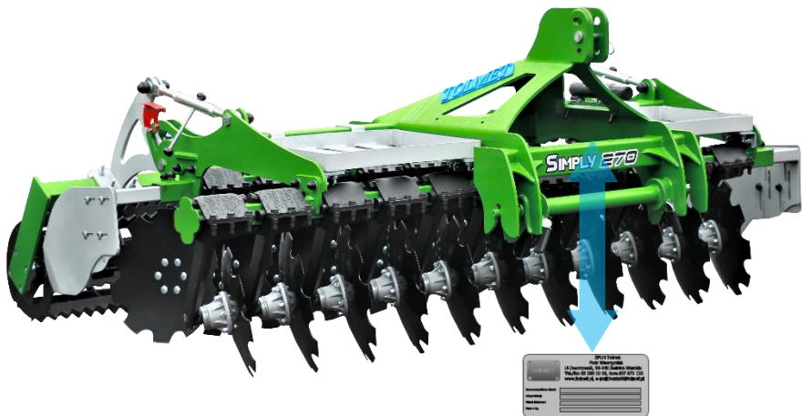
Zdj.1. Umieszczenie tabliczki znamionowej na maszynie.
