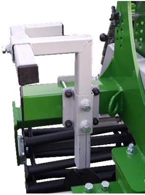
Zdj.10. Regulacja podpór kół siewnika
