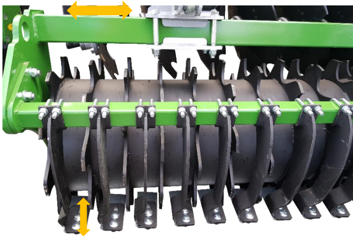
Zdj.11. Regulacja skrobaków wału zębatego
