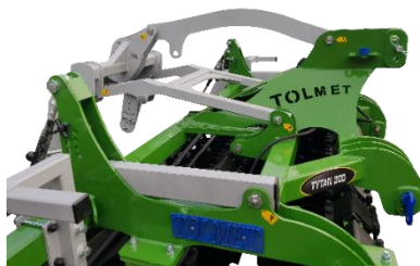
Zdj.12. Punkty smarowania maszyny
