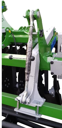
Zdj.6. Regulacja głębokości roboczej talerza
