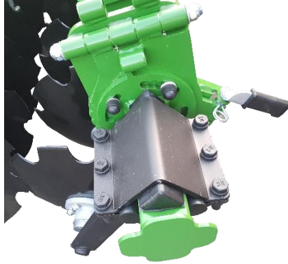
Zdj.5. Regulacja głębokości pracy talerza zewnętrznego
