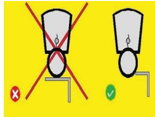
Zdj.10. Regulacja podpór kół siewnika
