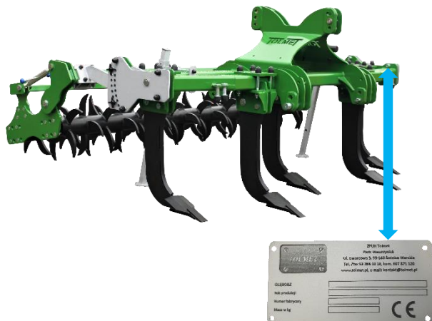
Zdj.1. Umieszczenie tabliczki znamionowej na maszynie.
